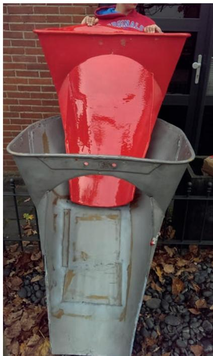
Das geringe Eigengewicht des Inliners ermöglicht dem Fahrzeugführer den einfachen Austausch im Verschleißfall.
