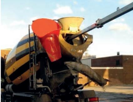
Während der Reinigung wird der Inliner einfach herausgenommen und oben am Fahrzeug abgelegt.
