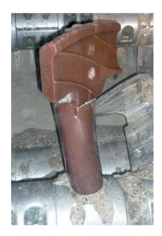
Mischwerkzeug im Einsatz. Geringe Betonanhaftungen erleichtern die Wartung und den Austausch.
