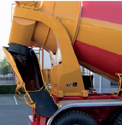
Beschichtung der Auslaufrinne eines Fahrmischers mit Funktionsplatte
